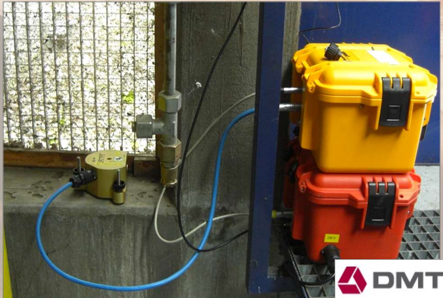
Immissionsmessstelle an einem Gebäudefundament, Überwachung Grenzwerte der DIN 4150
