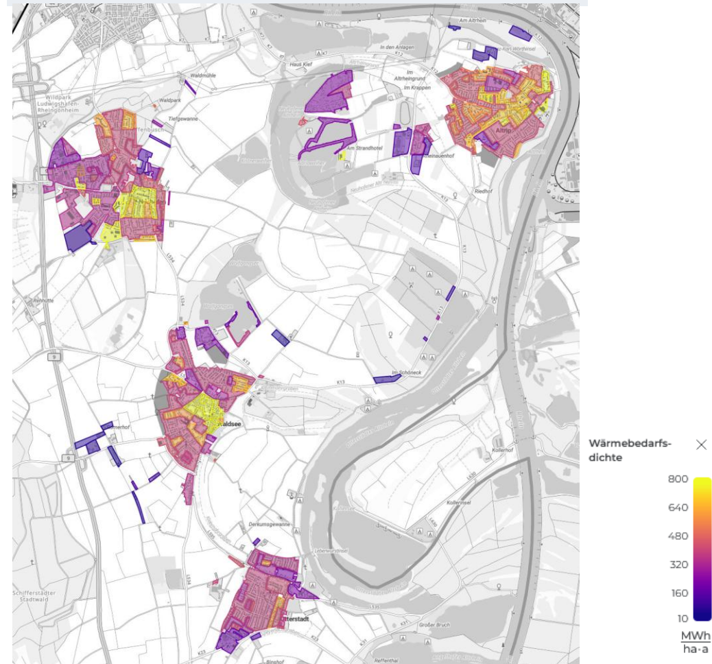
Wärmebedarfsdichte in MWh/ha
