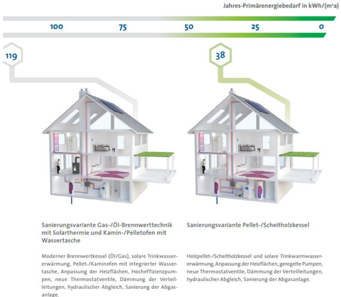
**Abbildung 24: Einsparpotenziale durch Kombination effizienter Anlagentechnik und energetischer Sanierung der Gebäudehülle**
