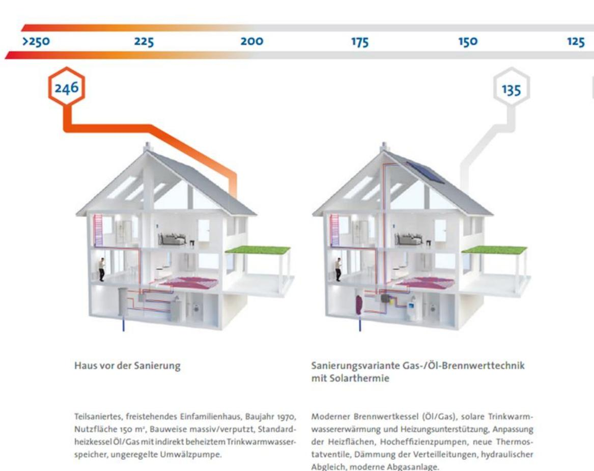
**Abbildung 23: Einsparpotenziale durch Nutzung effizienter Heiztechnik**
